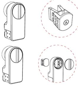
Si todo está correcto, fije la cerradura a la placa de montaje mediante los tornillos en ambos lados, antes de cerrar la cubierta de las pilas.
