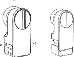
En caso de que sea necesario por el espesor de la puerta o la cerradura existente, utilice los accesorios para colocar la placa de forma adecuada
